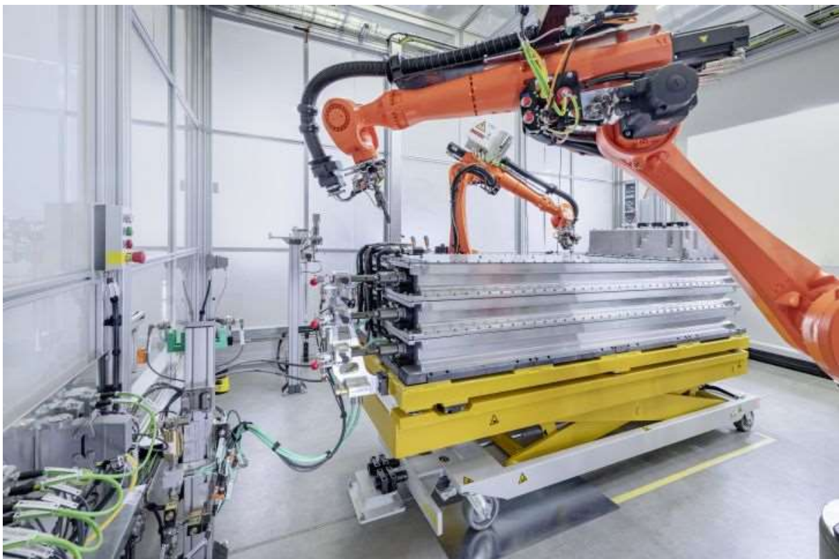
Roboter tasten die Batterie nach Leckstellen ab, an denen eingeführtes Gas austreten kann. (Bild: JW Froehlich)
