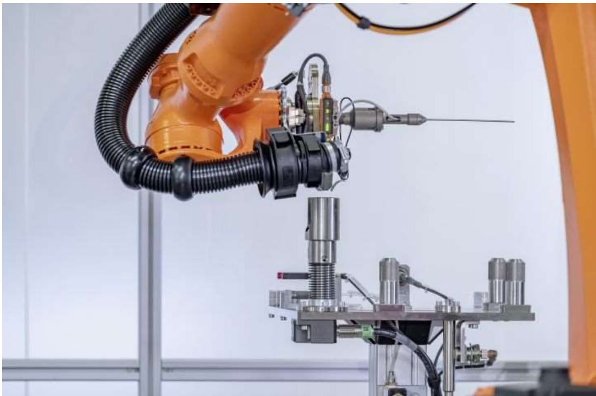
Bild 3: Eine Roboter geführte Schnüffelspitze fährt sämtliche potenzielle Leckstellen wie Verschraubungen oder Dichtungen ab. (Bild: JW Froehlich)
