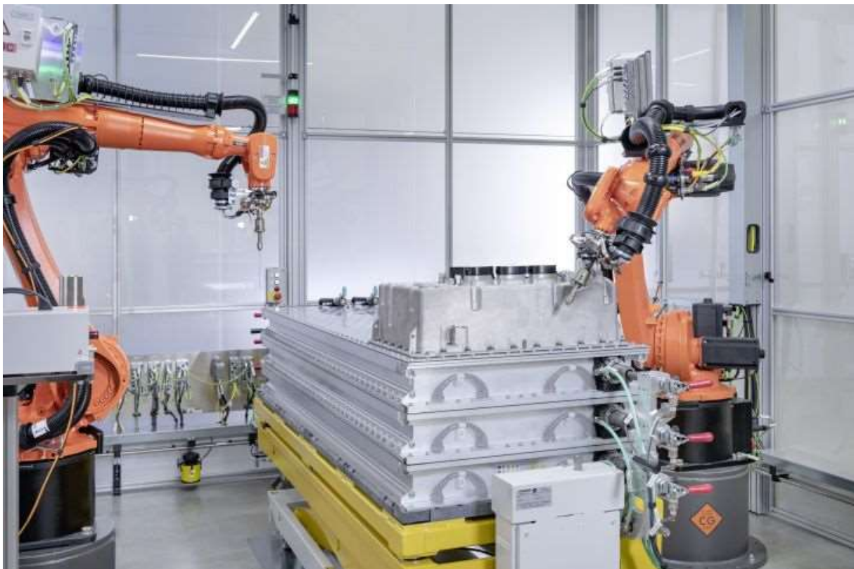
Dichtheitsprüfungen werden heute automatisiert mit Robotern durchgeführt. (Bild: JW Froehlich)
